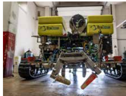
Med sina larvfötter tar sig denna trencher fram på havsbotten och gräver ner kabeln.
